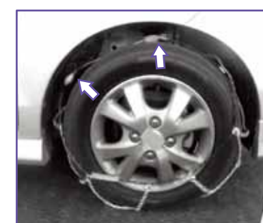
チェーンが車両内側に脱落
