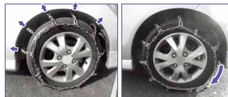
遠心力でチェーンが浮き上がる
