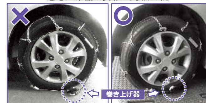
巻き上げ器が緩んでいる
